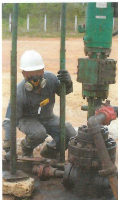
Figura 6 – Fechamento do anular e Manobra de válvulas Fonte: A autora, (2009)
